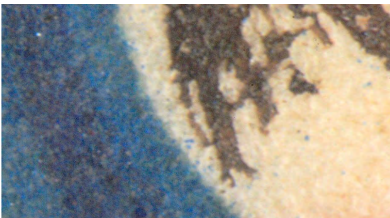
p. 73; grains de pigment bleu qui se sont détachés de la surface peinte
