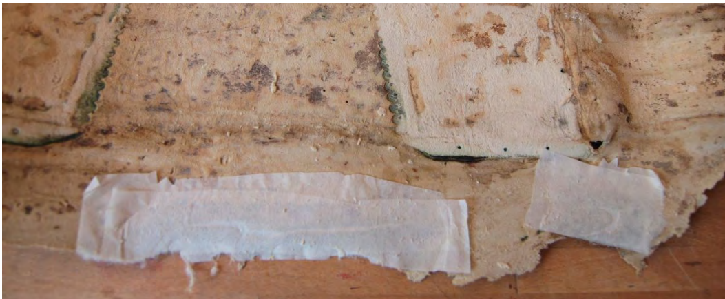
Fixage avec la technique du « facing » avec du papier japon des parties instables
