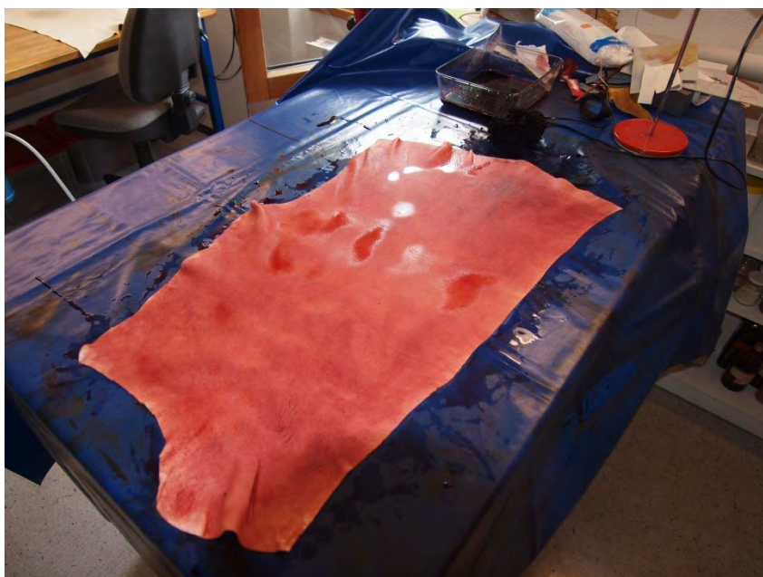
Teinture d'une pièce de cuir de chèvre mégissé à l'ancienne, pour la restauration des bords en cuir rose
