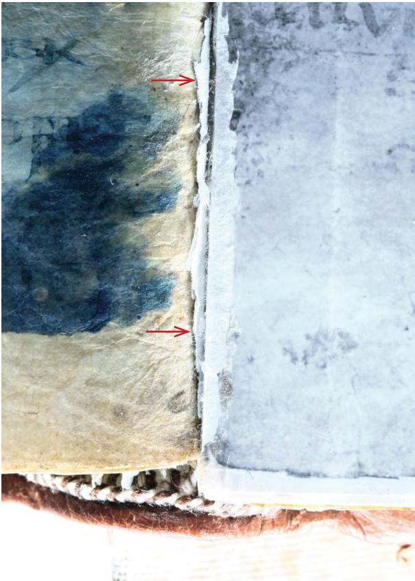
in Arbeit Lagenfalz: rote Pfeile: abgespaltene Schicht der Fotografie klebt auf dem Pergament
