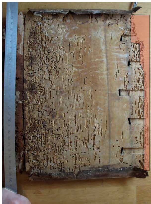
en cours: Vue après ouverture des remplis. La vermoûlure s'étant sur toute la surface de l'ais, qui présente également une lacune importante dans le mors (en rouge)
