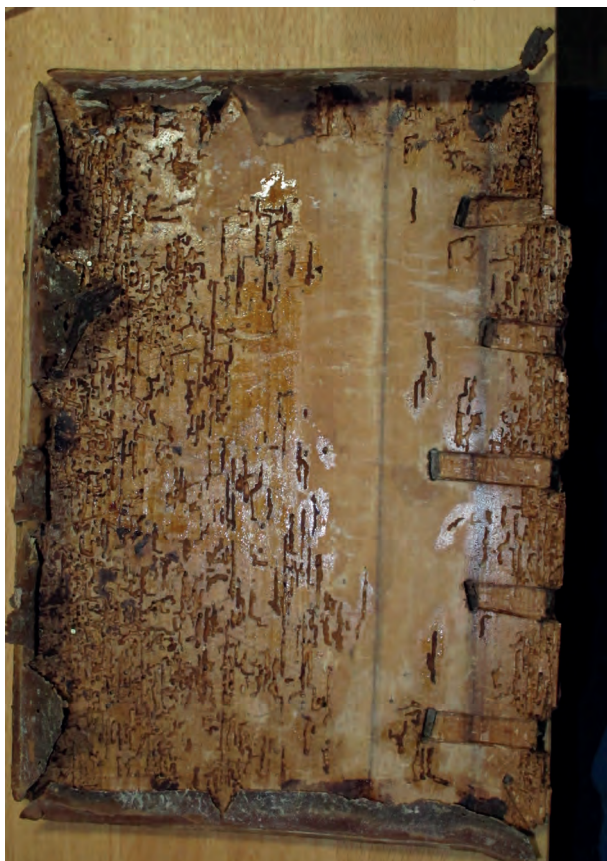
en cours: L'ais est plus stable après pénétration de l'Araldit et le bois est devenu légèrement plus sombre et brillant
