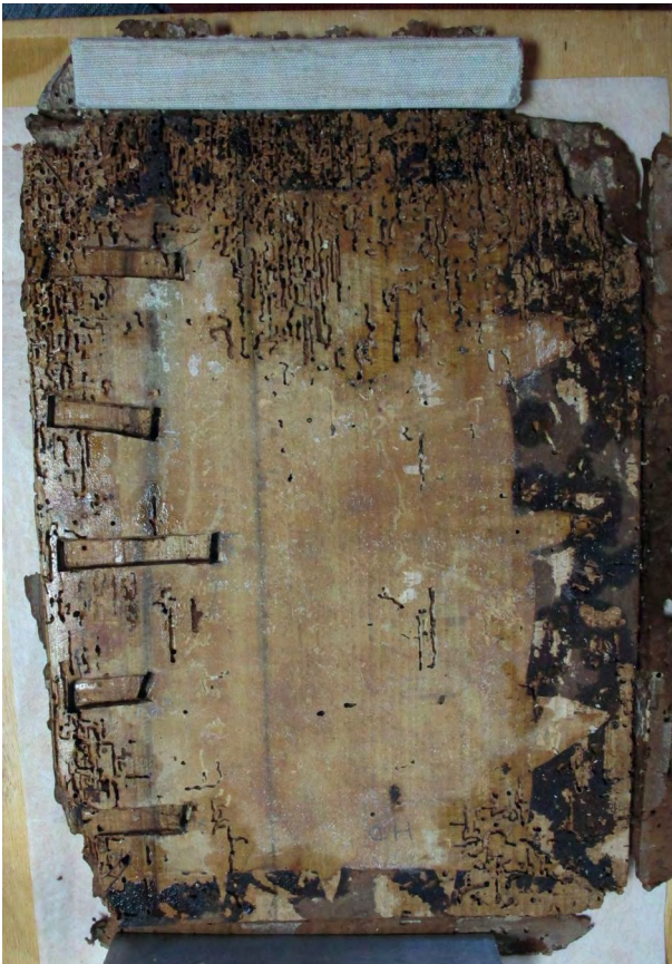
en cours: après pénétration de l'Araldit, les fines-parois des galeries sont plus stables. Le bois est devenu légèrement plus sombre et brillant.
