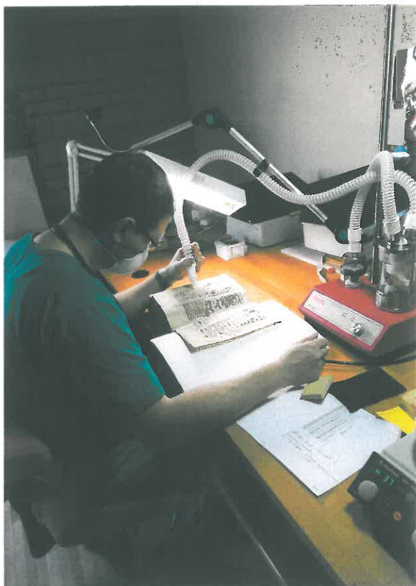
travaux en cours: fixation de l'encre et des pigments à l'aide d'adhésifs appliqués par nébulisation
